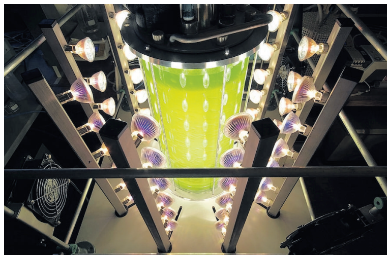
Proefopstelling algenkweek in Wageningen.
